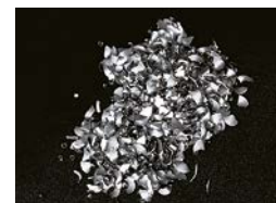
Durch LFV erzeugte Späne
