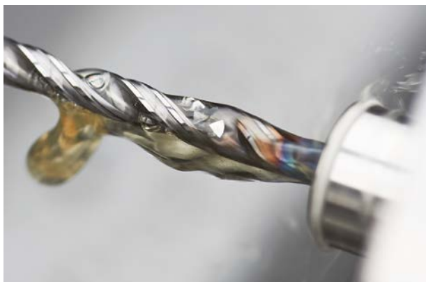
Tieflochbohren mit Bohrer mit Kühlkanälen: Die gebrochenen Späne werden durch die Spannuten des Bohrers nicht eingeklemmt, sondern problemlos abgeführt
